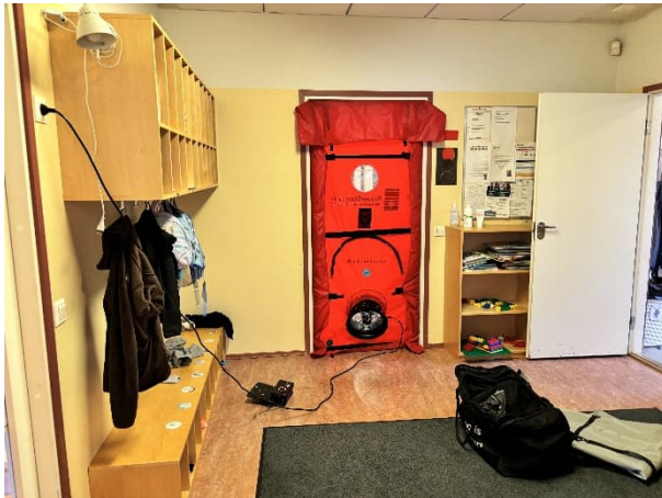
Kuva 127 Merkkiainekoe tehtiin alipaineistettuna.
