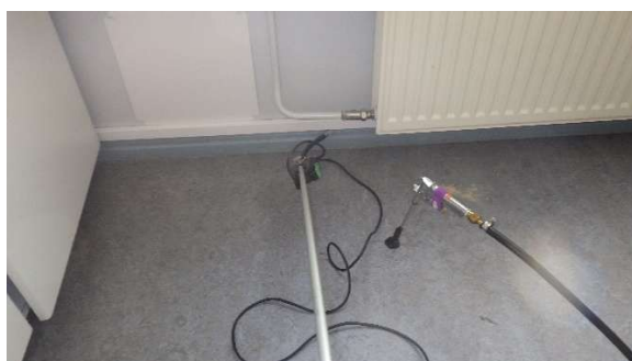
Kuva 12a-b. Merkkiainekokeissa havaittiin runsasta ilmavuotoa alapohjan ja ulkoseinän liitoksesta sekä ikkuna-ulkoseinä -liitoksesta.
