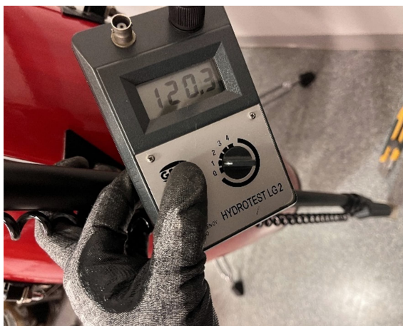
Kuva 34 Poikkeavia pintakosteusarvoja tilassa K18.
