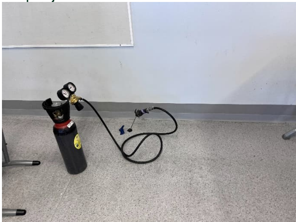
Kuva 148 Merkkiaiinekaasu laskettiin välipohjan eristetilaan.
