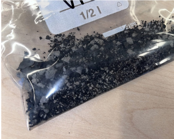
Kuva 65. Välipohjan täyttömateriaalia tilassa A206, arviolta koksikuonaa. s
