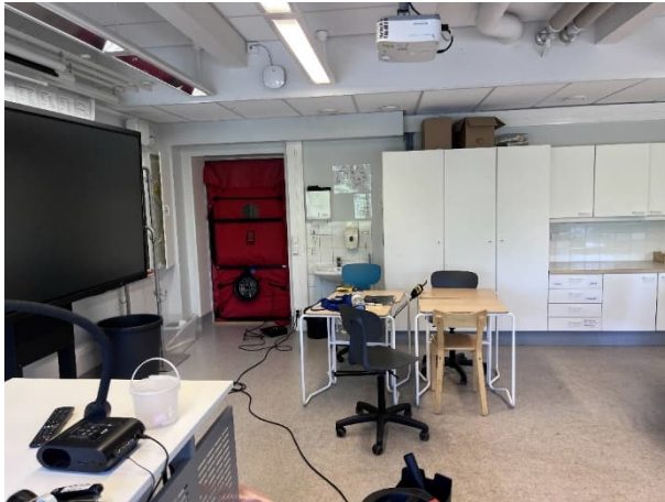
Kuva 150 Luokka 106 alipaineistettiin tutkimusten ajaksi.
