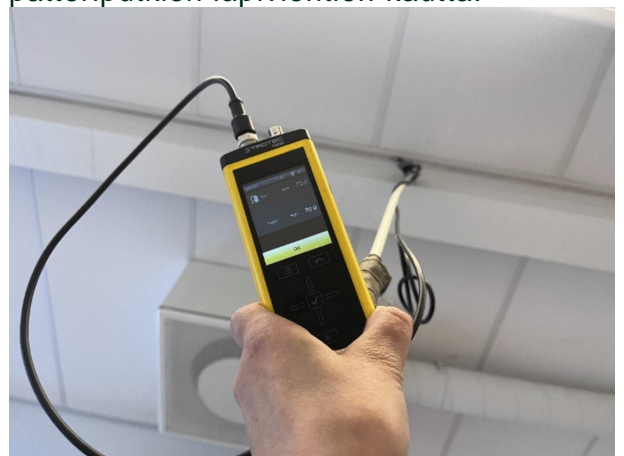
Kuva 155 Merkkiainekaasu kulkeutui yläpohjan eristetilasta alapuoliseen luokkaan.
