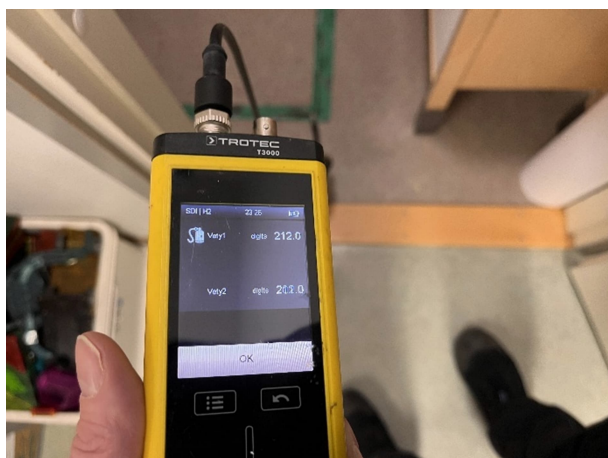
Kuva 102 Alapohjan eristetilaan laskettu merkkiainekaasu kulkeutui käyntiluukun kautta sisäilmaan.
