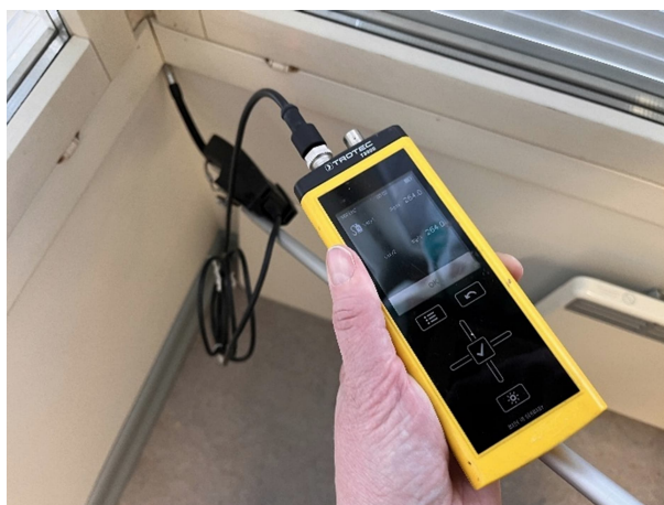
Kuva 103 Ulkoseinän eristetilaan laskettu kaasu kulkeutui sisäilmaan ulkoseinä-ikkunaliittymien kautta.
