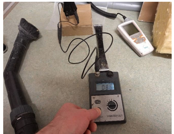
Kuva 49 US1. Puun kosteusmittausta.
