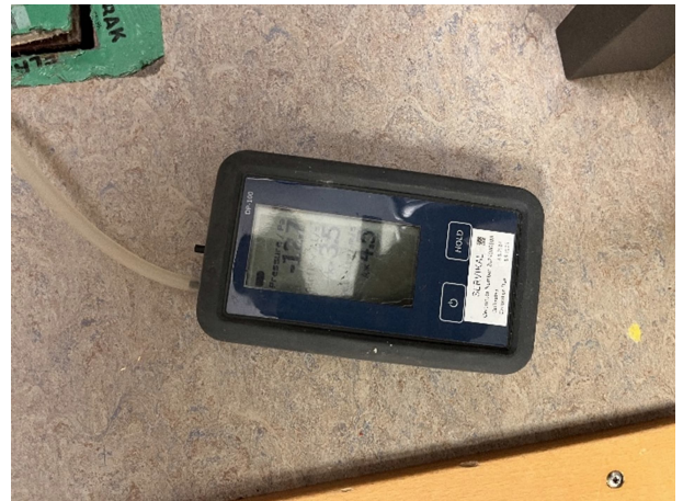
Kuva 101 Paine-ero ryömintätilan ja sisäilman välillä oli n. 10-12 Pa alipainetta.
