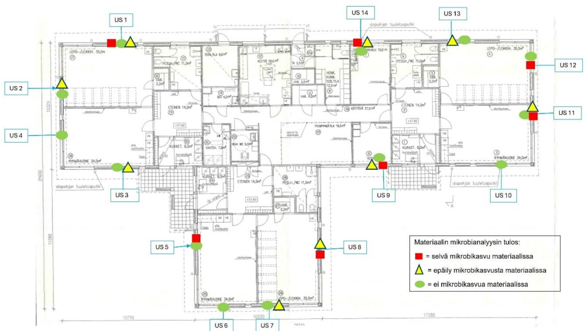
Kuva 54 Pohjakuva, jossa esitetty ulkoseinärakenteen rakenneavauksien sekä otettujen materiaalinäytteiden sijainnit. US= ulkoseinä. Mikrobivauriot on esitetty punaisella.
