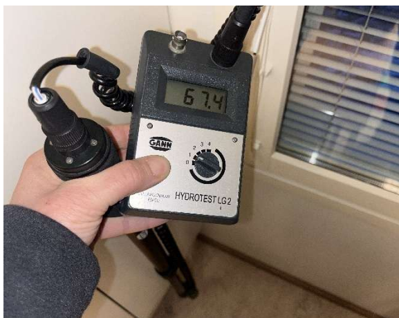
Kuva 20 Poikkeavia pintakosteusarvoja ei havaittu.
