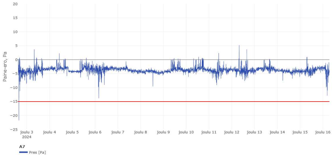
Kuva 130 Jatkuva toimiva paine-eromittaus tilassa 3. Punaisella viivalla merkitty -15 Pa paine-ero.
