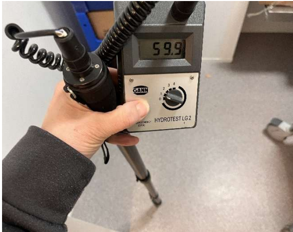
Kuva 22 Poikkeavia pintakosteusarvoja ei havaittu.
