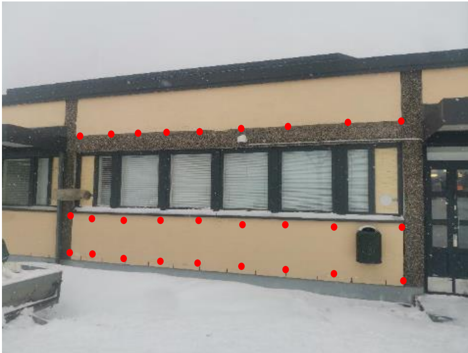
Kuva 3. Periaatekuva merkkikaasututkimuksessa poratuista kaasun syöttörei'istä.
