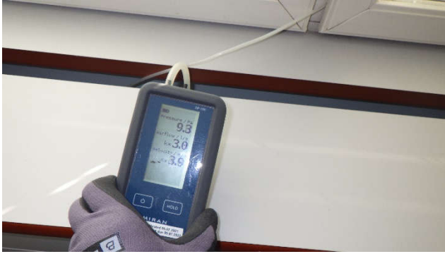
Kuva 13. Kotitalousluokka I oli n. 9 Pa ylipaineinen ulkoilman suhteen ennen tutkimusten aloittamista.
