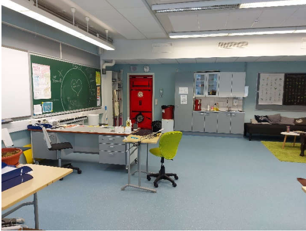
Kuva 1. Tutkittavat tilat alipaineistettiin keinotekoisesti merkkiainekokeen ajaksi n. 10-12 Pa alipaineikseksi ulkoilmaan nähden.
