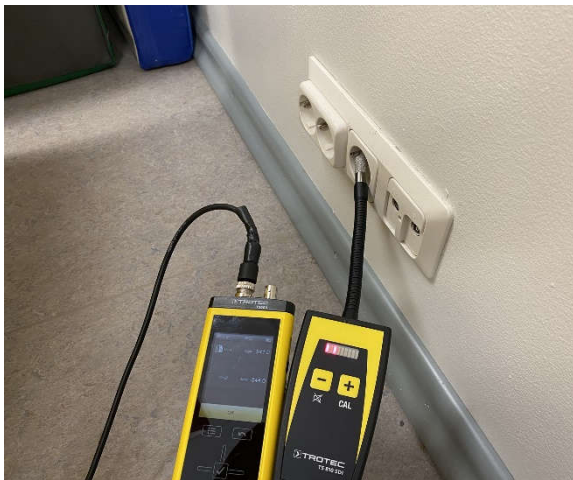
Kuva 11. Merkkiainekokeessa havaittiin ilmavuotoa mm. sähköpistorasioiden kautta.
