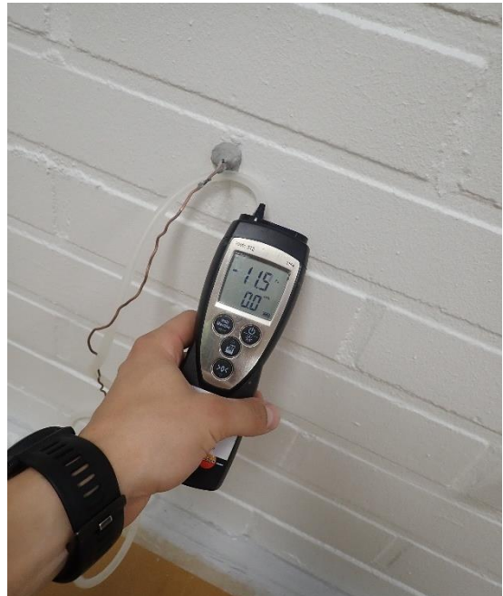
Kuva 5 a ja b. Merkkiainekekeen MA2 tutkimusjärjestelyt. Tila alipaineistettiin Blower-door-puhallinlaitteistolla. Paine-ero ulkoseinärakenteen eristetilan ja tutkittavan tilan välillä varmistettiin Testo 512-paine-eromittarilla ja paine-eroa seurattiin säännöllisesti tutkimuksen aikana. Muut kokeet suoritettiin vastaavalla periaatteella.
