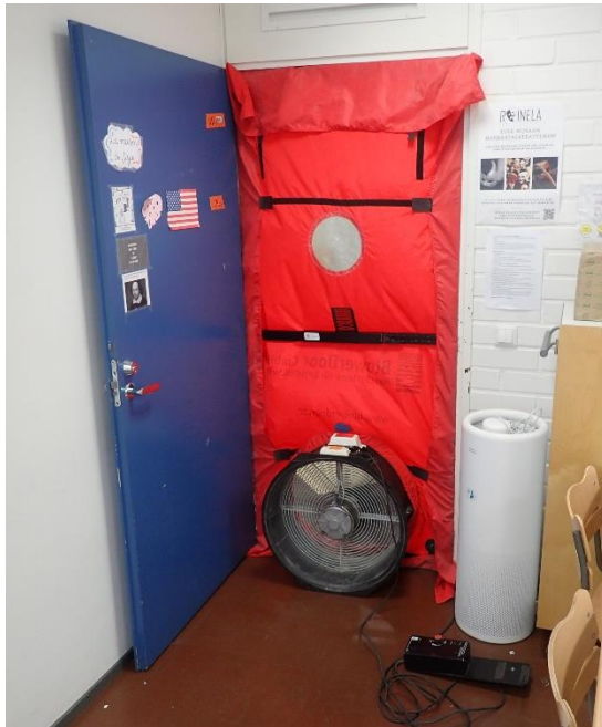
Kuva 5 a ja b. Merkkiainekekeen MA2 tutkimusjärjestelyt. Tila alipaineistettiin Blower-door-puhallinlaitteistolla. Paine-ero ulkoseinärakenteen eristetilan ja tutkittavan tilan välillä varmistettiin Testo 512-paine-eromittarilla ja paine-eroa seurattiin säännöllisesti tutkimuksen aikana. Muut kokeet suoritettiin vastaavalla periaatteella.
