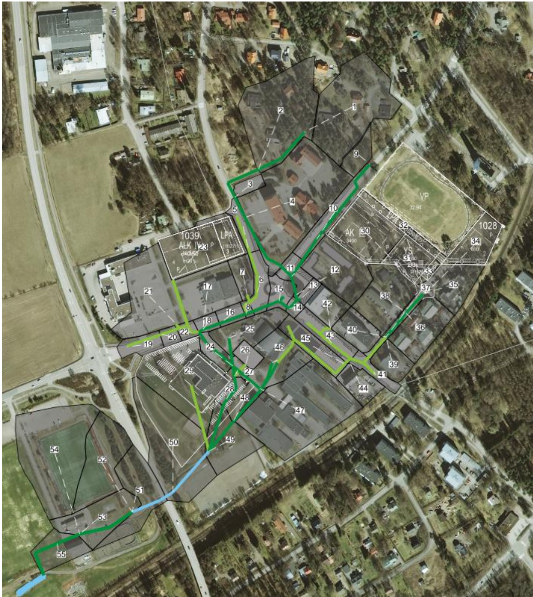
Kuva 4.1. Osavaluma-aluejako ja malliin syötetty hulevesiverkosto
