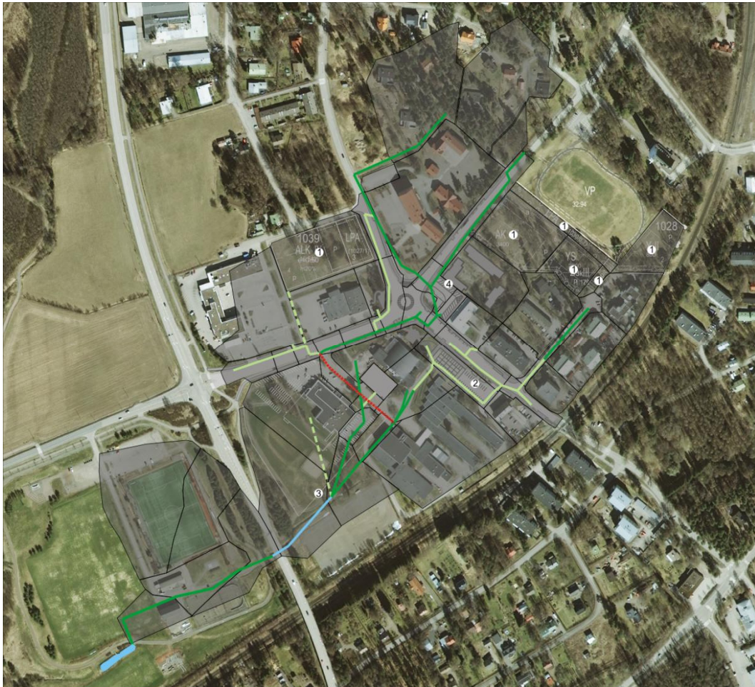
Kuva 5.1. Vaihtoehto 1: Hulevesiä viivytetään kaavoitetuilla alueilla 10 mm/1ha vettäläpäisemätöntä pintaa kohti (nro 1), jonka lisäksi hulevesiä viivytetään torin pysäköintialueella (nro 2, 100 m 3 /h), verkoston purkupisteessä (nro 3, 500...550 m 3 ) ja pikkuaukiolla (nro 4, 120 m 3 ). Kuvassa uusittavat verkosto-osuudet on merkitty punaisella (kasvihuooneilmiön vaikutus pisteiviivalla), nykyinen verkosto tummanvihreällä, uusi verkosto vaaleanvihreällä ja oja sinisellä.
