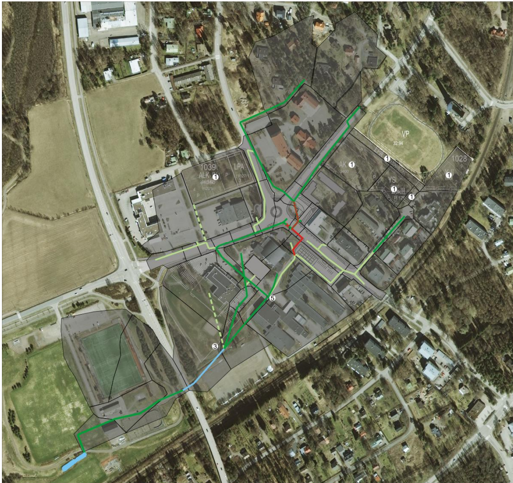
Kuva 5.5. Vaihtoehto 5: Tykkimäentieltä Arenkujalle rakennetaan uusi linja. Hulevesiä viivytetään kaavoitetuilla alueilla 10 mm/1ha vettäläpäisemätöntä pintaa kohti (nro 1), jonka lisäksi hulevesiä viivytetään Rajamäen yläkoulun ja lukion pihalla (nro 5, 450 m 3 ) ja verkoston purkupisteessä (nro 3, 300 m 3 /h). Kuvassa uusi yhdyslinja (Tykkimäentie-Arenkuja) on merkitty punaisella, nykyinen verkosto tummanvihreällä, uusi verkosto vaaleanvihreällä ja oja sinisellä.
