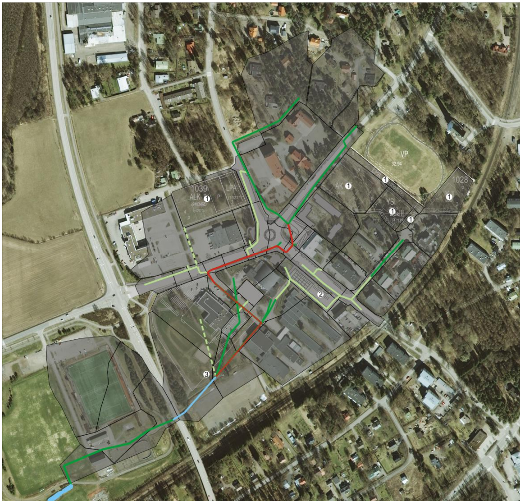
Kuva 5.2. Vaihtoehto 2: Hulevesiä viivytetään kaavoitetuilla alueilla 10 mm/1ha vettäläpäisemätöntä pintaa kohti (nro 1), jonka lisäksi hulevesiä viivytetään torin pysäköintialue-
