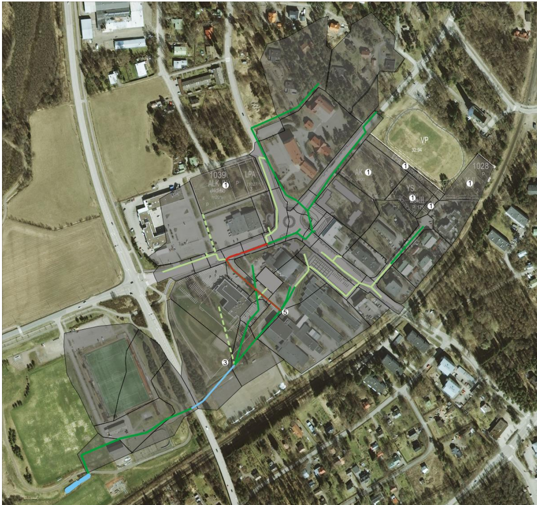
Kuva 5.4. Vaihtoehto 4: Hulevesiä viivytetään kaavoitetuilla alueilla 10 mm/1ha vettäläpäisemätöntä pintaa kohti (nro 1), jonka lisäksi hulevesiä viivytetään Rajamäen yläkoulun ja lukion pihalla (nro 5, 300...400 m 3 ) ja verkoston purkupisteessä (nro 3, 300...400 m 3 ). Kuvassa uusittavat verkosto-osuudet on merkitty punaisella (kasvihuoneilmion vaikutus pisteiviivalla), nykyinen verkosto tummanvihreällä, uusi verkosto vaaleanvihreällä ja oja sinisellä.
