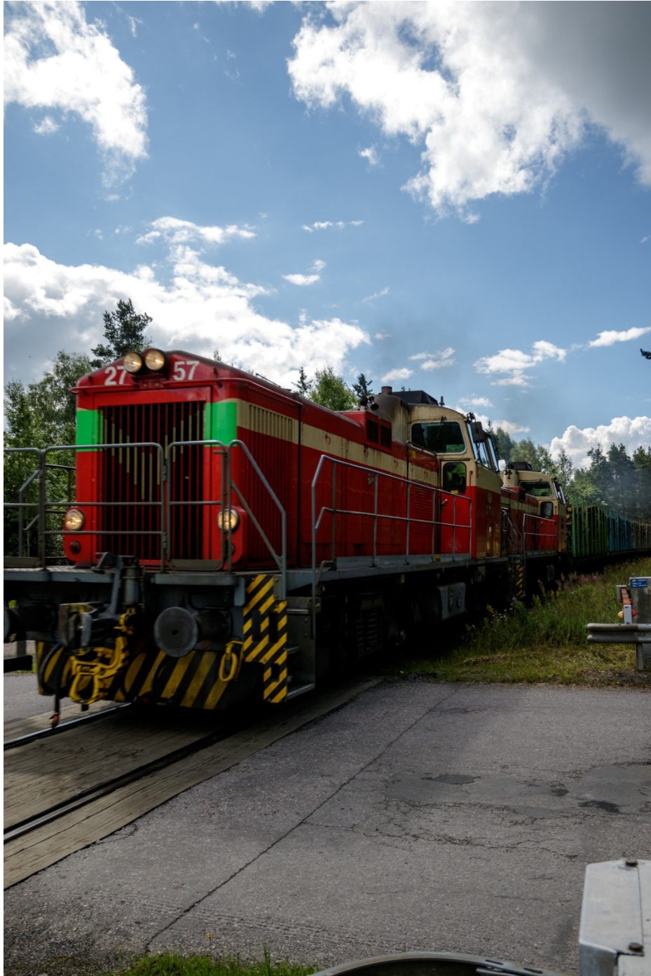
Kuva 6. Saunatien läheisellä Isokalliontien tasoristeyksessä VR:n Dv12 dieselveturit kuljettavat puukoormaa kohti Hyvinkäättä.
