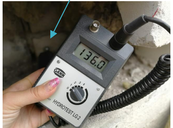
Kuva 50 Pintakosteuden ilmaisimella pilarissa havaittiin viitteitä kohonneesta kosteudesta (US9).
