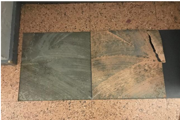
Kuva 30 Vinyylilaatan alapinnan kuntoa tarkasteltiin myös aistinvaraisesti (BULK 5).
