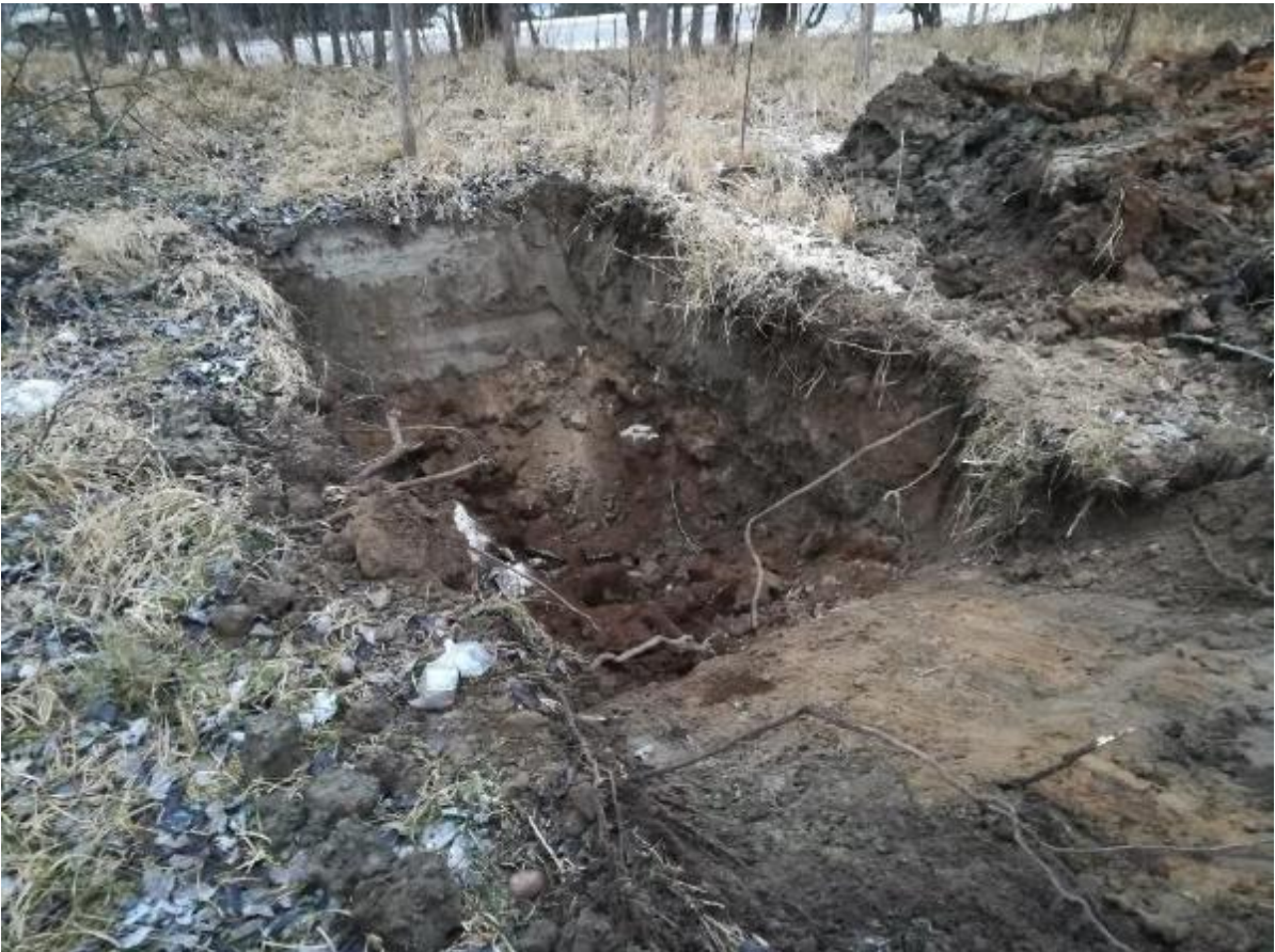
Kuva 2. KK2. Pisteessä 1,5 m syvyydellä esiintyi louhetta, josta ei päästy syvemmälle.
