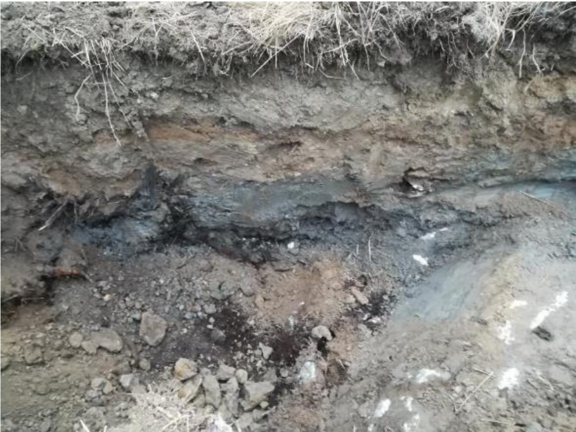
Kuva 4. KK 3. Pinnassa ohut humuksesta, hiekasta ja siltistä koostuva kerros. Tämän alapuolella erilaisia täyttömaasta koostuvia kerroksia 2,2 m syvyydelle saakka.
