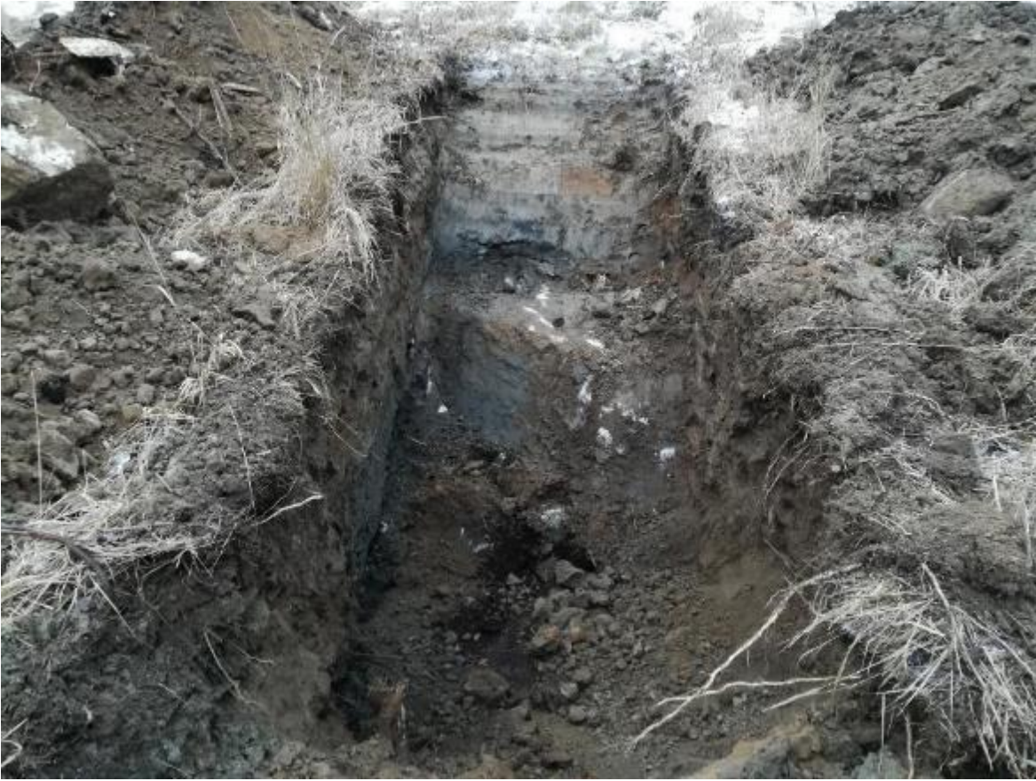
Kuva 3. KK3. Pisteessä kallio lasi viistosti koekuopan mukaisesti syvyydelle 2,2 m.
